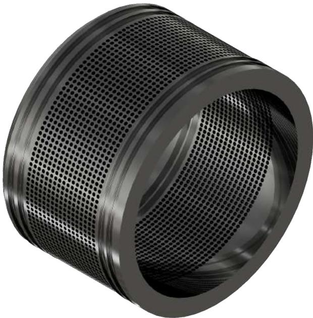
Сепараторы с линейной характеристикой устанавливаются как на регулирующие, так и на запорно-регулирующие осевые клапаны. Необходимы для регулирования расхода рабочей среды по линейной характеристике. При установке сепараторов с линейной характеристикой, пропорциональное изменение положения поршня клапана приводит к пропорциональному изменению расхода рабочей среды.
